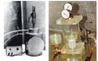
Figura 10. Dos modelos de aceleradores de micropartículas o “pistolas génicas”, desarrolladas en nuestro laboratorio. En el de la izquierda (A) se usa la explosión de pólvora para provocar la aceleración, mientras que en el de la derecha (B) se utiliza helio comprimido.
