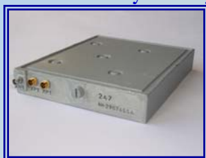
Сверхвысокочастотное передающее устройство
