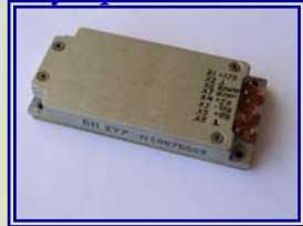
Блок питания приемных устройств
