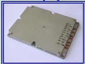
Блок питания передающего устройства
