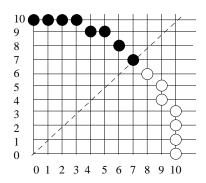
El procedimiento siguiente despliega una circunferencia de rastreo utilizando el algoritmo de punto medio. La entrada para el procedimiento son las coordenadas para el centro y radio de la circunferencia.
