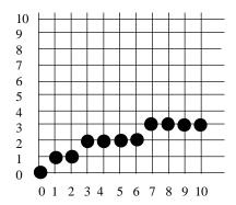
El siguiente procedimiento despliega una parábola de rastreo utilizando el algoritmo de punto medio.
